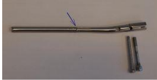
Fig. 4.34 Imagine macroscopică a tijei centromedulare Siedel cu indicarea zonei de rupere
