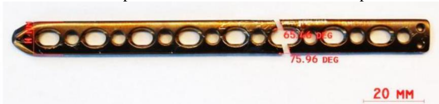
Fig. 4.11 Macrografia explantului de tip LCP
