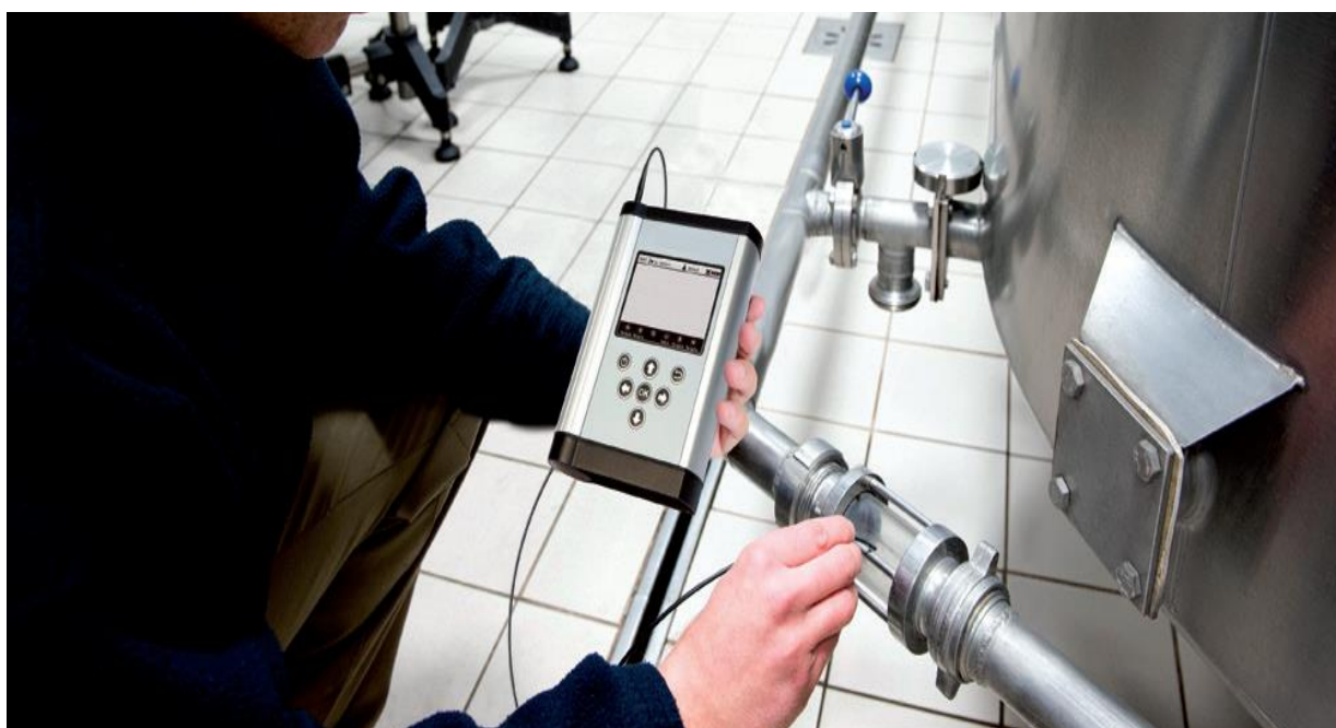
Fig. 14. Dispozitiv non-invaziv de măsurare a concentrației de oxigen dizolvat
