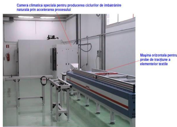
Fig. 2.2. Zona interioară a Laboratorului de Elemente de Securitate pentru teste statice de rezistență și teste de îmbătrânire accelerată.
