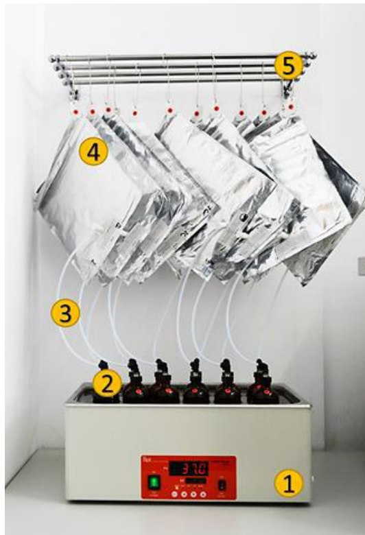
Figura 3.7. Instalație experimentală pentru efectuarea testelor BMP: (1) baie de apă termostată; (2) sticlă de fermentare brună; (3) tub conector din teflon; (4) sac de colectare gaz multi-strat; (5) sistem de agățare (Dima et al., 2020)
