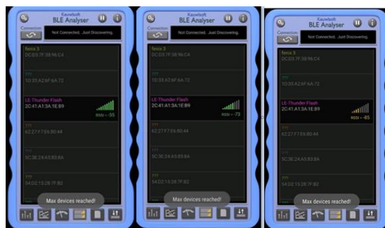
Fig. 5.30. Nivelul RSSI al căștilor bluetooth la diferite distanțe
