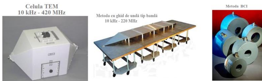
Figura 6.2: Metode de testare ISO 11452: Celula TEM, metoda stripline, metoda BCI [19]
