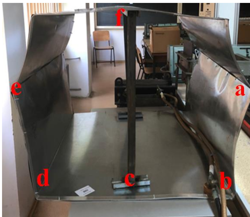
Figura 7.6: Ambele cabluri alăturate, poziționate în dreapta caroseriei – punctele de măsurare reprezentate
