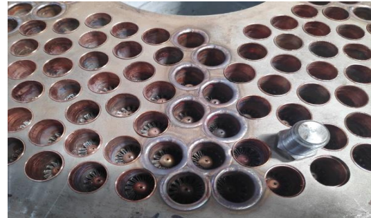
Figura 21 – Gruparea și sudarea sectoarelor de câte 10 țevi pe placa tubulară
