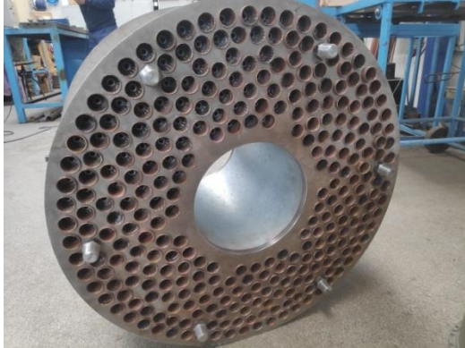
Figura 17 - Ansamblul schimbător de căldură înaintea procesului de sudare
