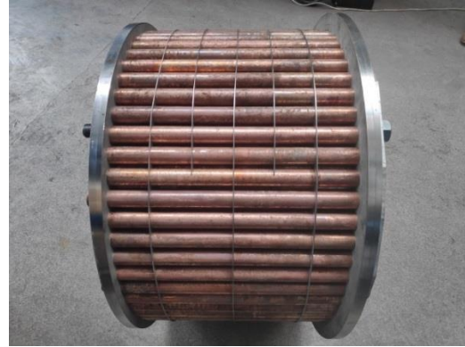
Figura 17 - Ansamblul schimbător de căldură înaintea procesului de sudare
