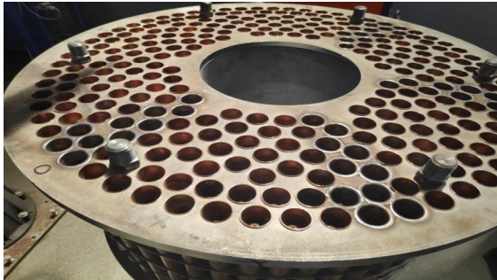
Figura 21 – Gruparea și sudarea sectoarelor de câte 10 țevi pe placa tubulară
