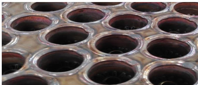
Figura 25 – Cordoane de sudură realizate prin definirea a 5 puncte pentru fiecare țevă în sistemul robotic
