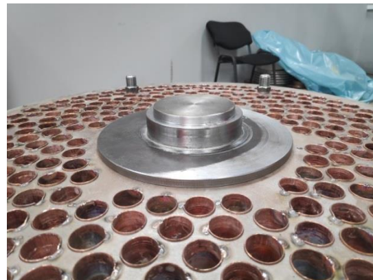
Figura 18 - Varianta finală a dispozitivului de centrare și fixare “Amifix”
