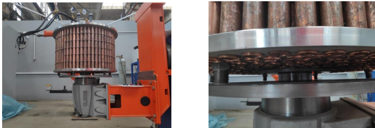
Figura 19 - Fixarea și centrarea piesei cu dispozitivul “Amifix” pe masa sistemului robotic
