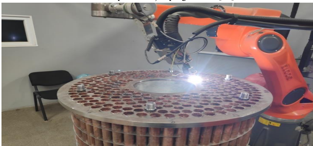
Figura 20 - Sudarea pilot a șirului circular de țevi pe placa tubulară
