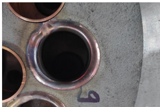
Figura 12 – Imaginea zonelor sudate în cazul imbinării țevii de cupru cu referință 9 în cadrul piesei test a schimbătorului de căldură
