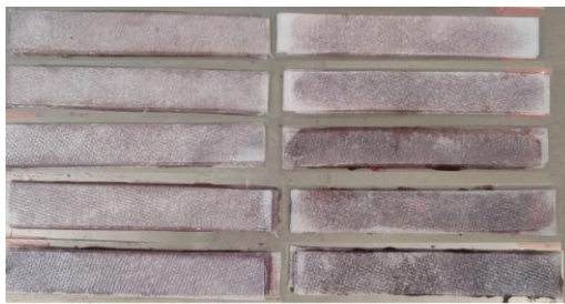
Figura 6.1. Realizarea epruvetelor pentru încovoiere din materiale compozite ce înglobează sistemele de auto-reparare
