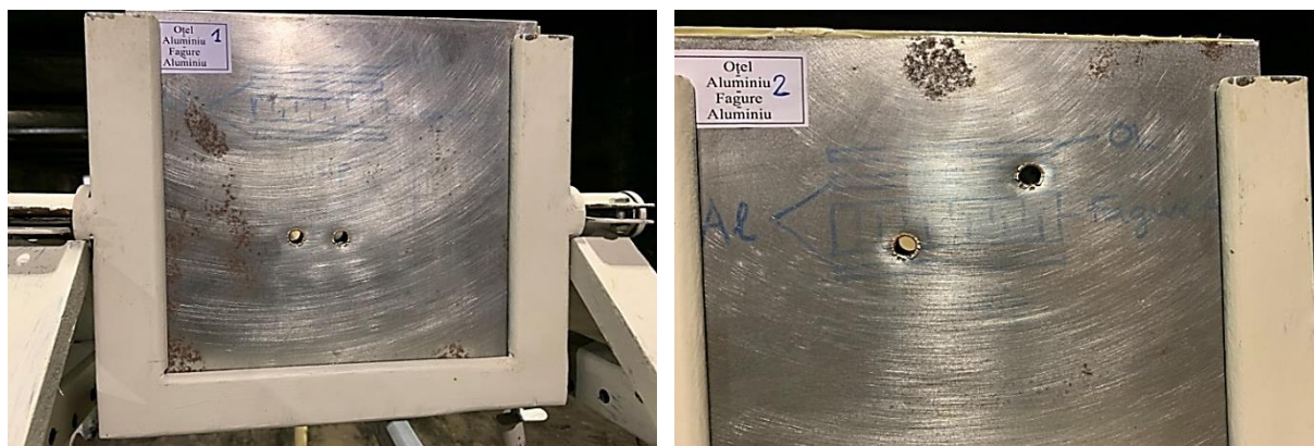
Fig. 4.6 Plăci OI-Al-F-Al - 2 x 7,62 mm - vedere față impactată
