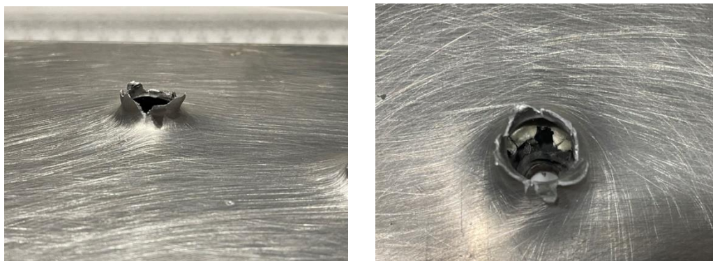
Fig. 4.10 Aspectul găurii după impact placă OI-Al-F-Al - testare experimentală
