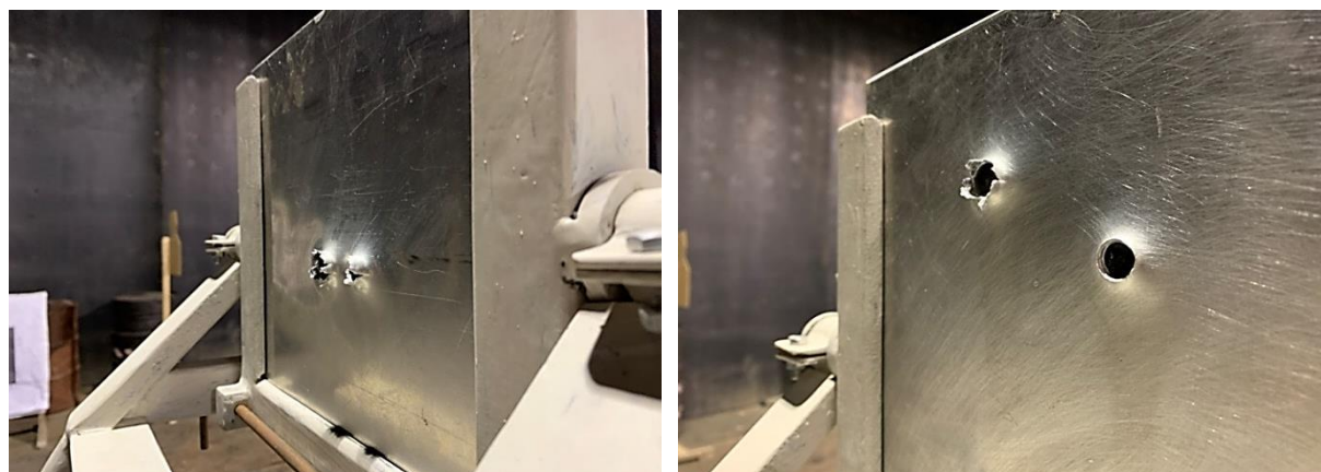
Fig. 4.7 Plăci OI-Al-F-Al - 2 x 7,62 mm - vedere din spate
