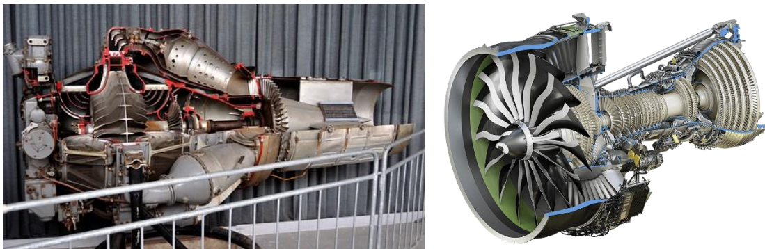
Figura 1.5. Motorul turboreactor RD45, cu forța de tracțiune maximă de 12 TF [8] Turbofanul GE9X, cu forța de tracțiune maximă de 50 TF [30]
