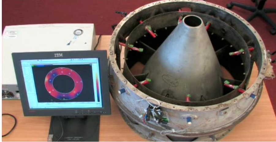
Figura 4.14. Ajutaj de reacție cu sistem-prototip de instrumentare wireless [82]
