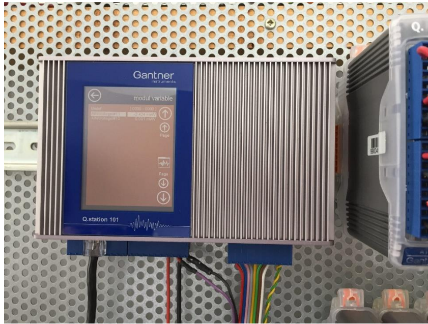
Figura 5.11. Sistem de achiziție și control date format din Q.station și Q.series
