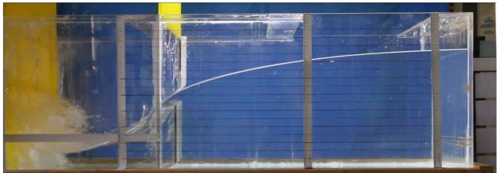
Figura 5.3 Cazurile experimentale de rupere a undei de golire dinspre secțiunea mică înspre secțiunea mare și viceversa pe înălțimile statice precizate
