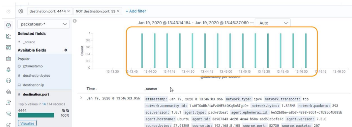
Figura 3.15 Detecția anomaliilor pe baza intervalelor de timp dintre conexiuni.
