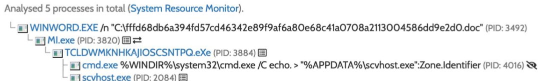
Figura 4.11 Ierarhia de execuție a proceselor în cadrul infectării cu Stampado.
