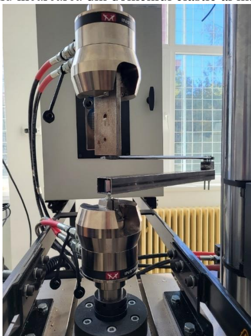
Fig. 7.2 Poziționarea palei compozite în interiorul echipamentului de încercare
