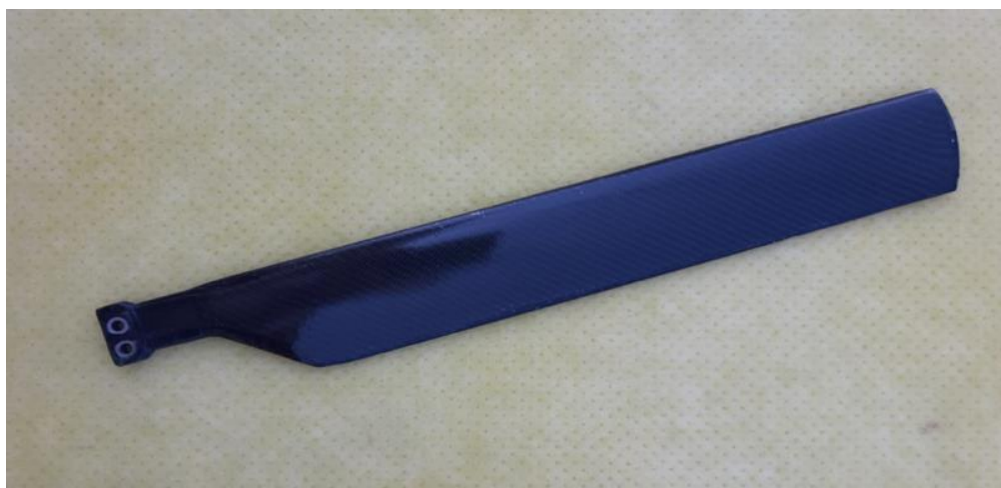
Fig. 7.1 Pala anticuplu realizată la scara 1:3 din materiale compozite
