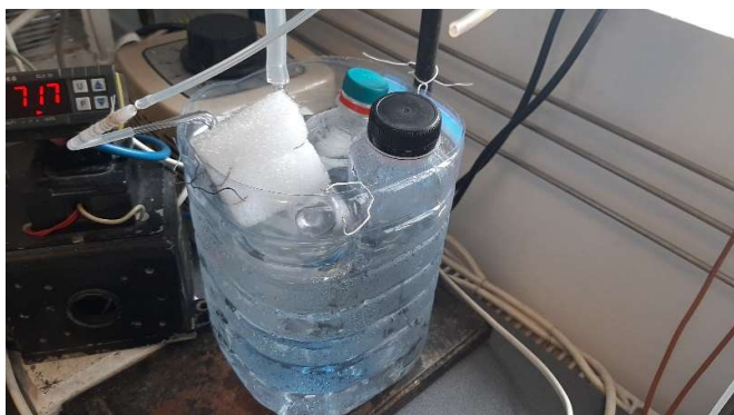
Fig. 2.9. Trapă de răcire (3 – 4 °C) pentru condensarea vaporilor de apă care părăsesc reactorul
