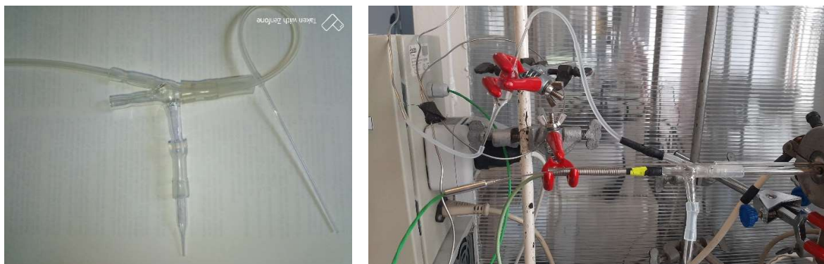
Fig. 2.8. Piesa de introducere a amestecului de reactanți și a apei în reactor — stânga - piesa T-Y cu 3 intrări (sus: furtun apă, mijloc: sonda temperatură, jos: intrare amestec reactanți/ hidrogen - regenerare) și o ieșire – dreapta – vedere de ansamblu în instalație a piesei T-Y (prinsă în clema roșie se observă bula de sticlă ce asigură coloană de apă ce nu permite amestecului de reactanți să părăsească tubul de reacție pe traseul de injectare a apei)
