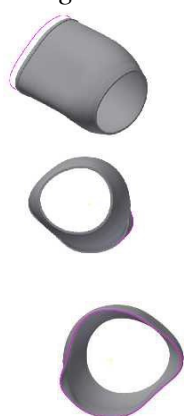
Fig. 5.45. Componentele cupei pentru varianta umplerii cu rășină epoxidică și mat de fibră de sticlă - Prima componentă (interior)
