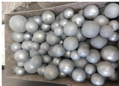
Fig.6.29 Bile de macinare de diferite dimensiuni, [19]
