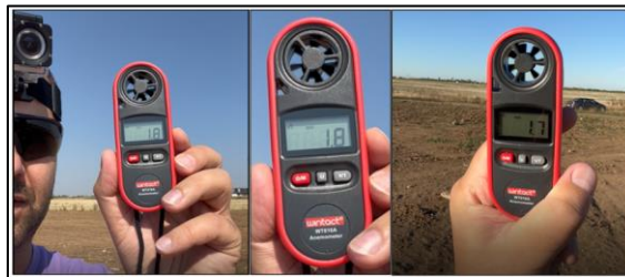
Fig. 4.14 Măsurarea vitezei vântului cu ajutorul anemometrului
