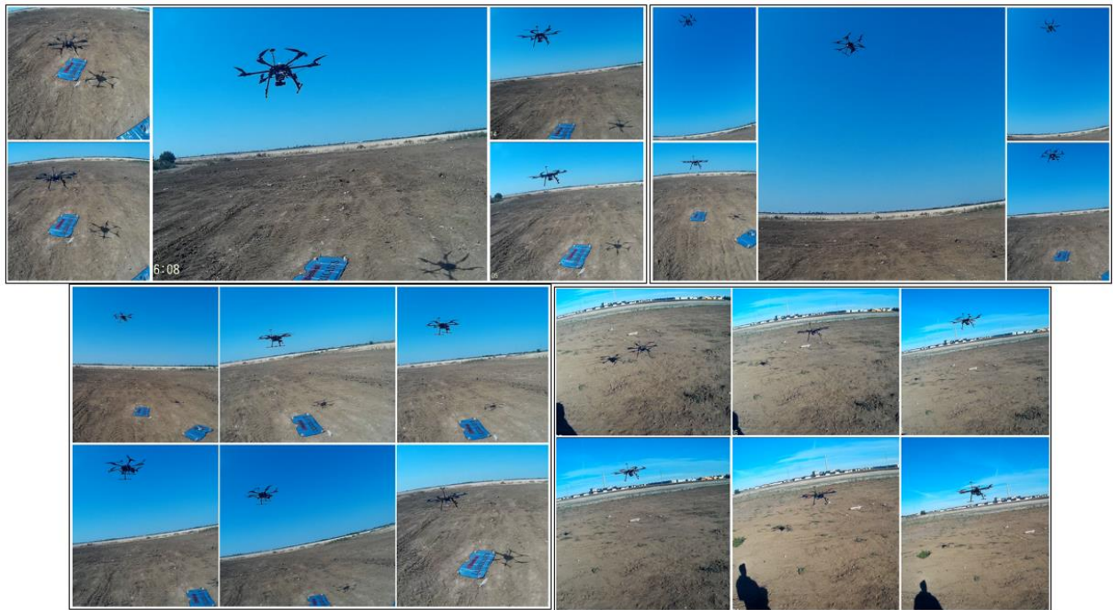
Fig. 4.15 Testarea dronei în zbor staționar la punct fix – etapele zborului
