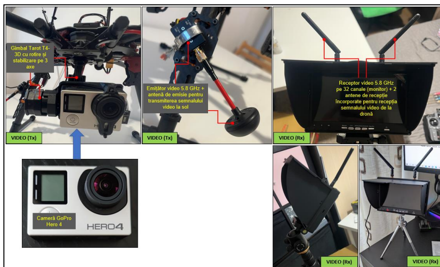
Fig. 4.8 Lanțul de emisie-recepție a semnalului video de la dronă la operator
