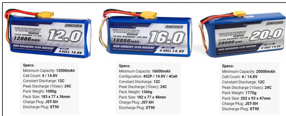
Fig. 4.10 Acumulatori LiPo Turnigy cu capacități de 12Ah, 16Ah, respectiv 20Ah [48]
