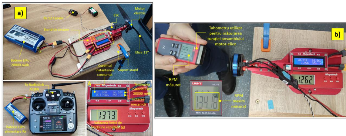
Fig. 3.16 a) Configurația standului de testare a eficienței sistemului de propulsie; b) Măsurarea turației ansamblului motor-elice
