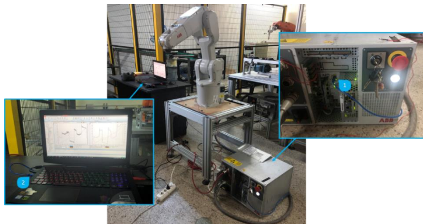
Fig. 3.9. Configurația experimentală formată dintr-un robot articulată IRB 1200, cu conexiune între controlerul IRC5 (1) și laptopul pe care rulează RobotStudio (2).
