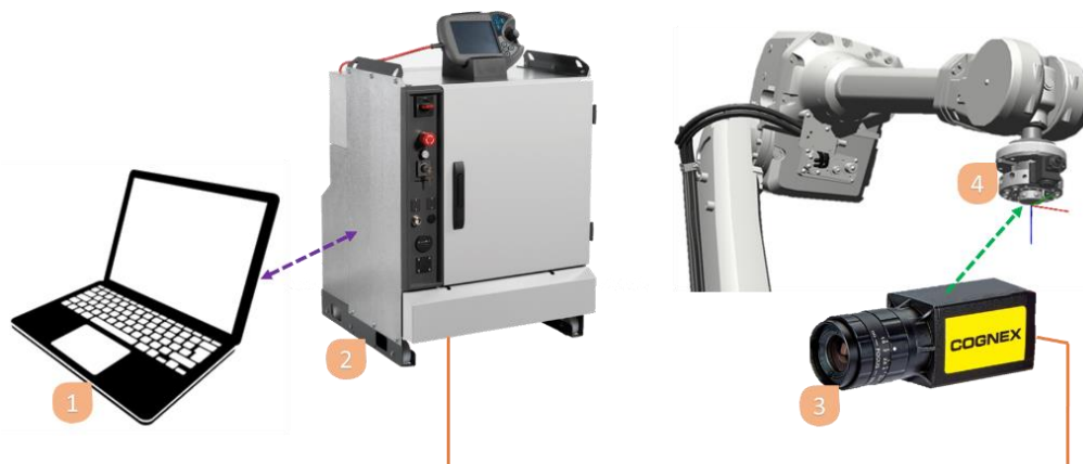
Fig. 4.5. Echipamentele folosite pentru sistemul de viziune: PC-ul pe care rulează ABB RobotStudio (1), controlerul robotului (2), camera Cognex 8400 (3), sistemul ATC (4).
