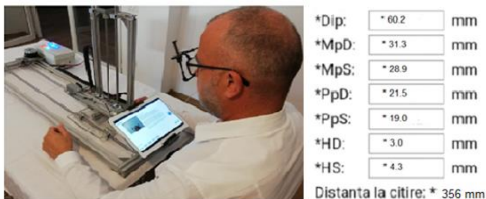
Fig.6.11. Parametrii mășurați în poziția „scris/citit „
