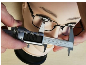
Fig.6.6. Măsurarea cu șublerul a distanței pupilare a manechinului (64,77 mm) [67]
