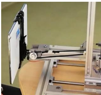
Fig.6.1. Tableta montată în suportul special, atașat brațului dispozitivului
