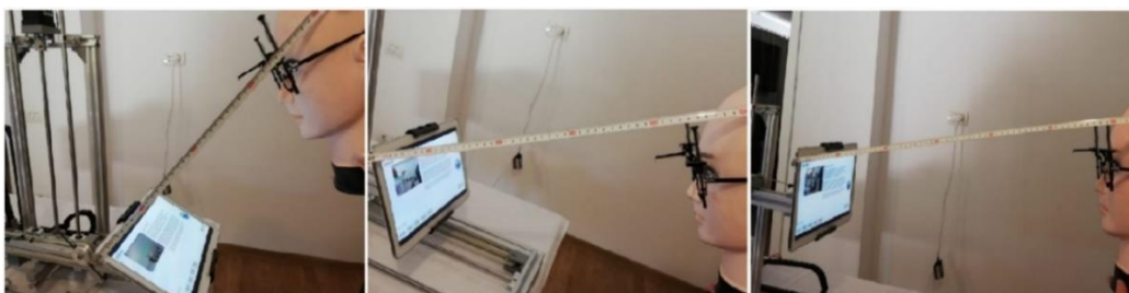
Fig.6.7. Măsurarea cu ruleta a celor trei poziții pentru aproape (350mm/450mm/650mm) a manechinului Rezultatele obținute la măsurarea dimensiunilor manechinului sunt prezentate în tabelul 6.1.
