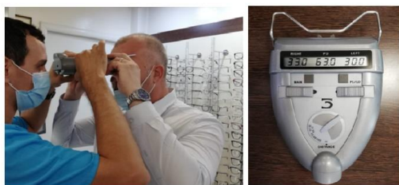
Fig.6.26 Distanța interpupilară măsurată cu pupildimetrul electronic ( George Baboianu )
