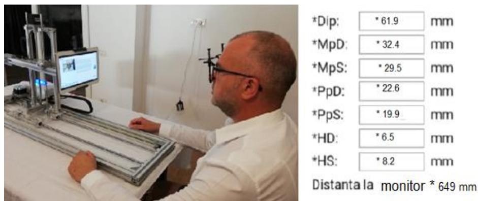
Fig.6.13. Parametrii mășurați în poziția „monitor„
