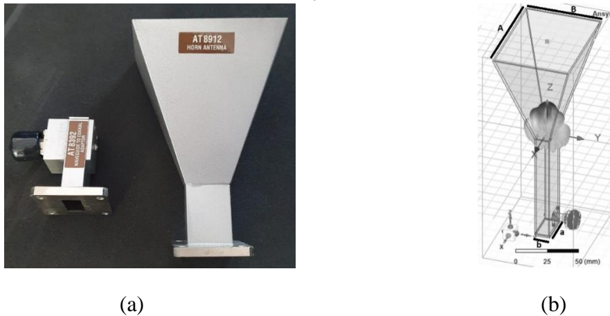
Figura 6.14 Antena horn piramidal: antena horn AT8912 (a) și modelul antenei în programul Ansoft HFSS
