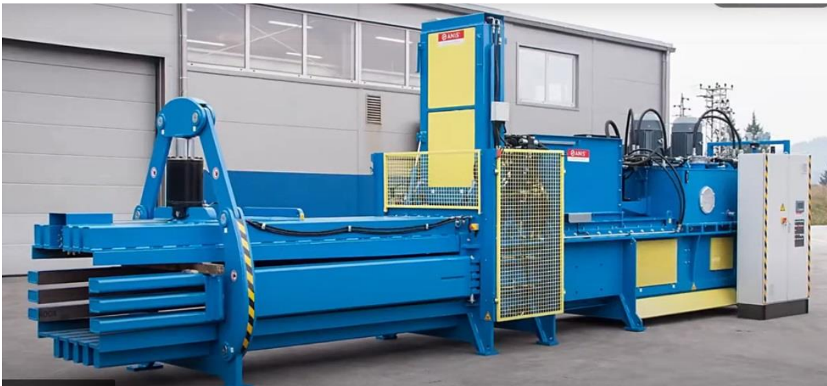
Fig.6.25. Vedere de ansamblu a preseii orizontale pentru baloți din deșeuri reciclabile
