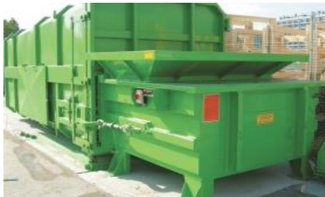
Fig. 3.8. Sisteme de compactare prin translație , cu amplasare fixă , pentru deșeurile din materiale de construcții și container detașabil
