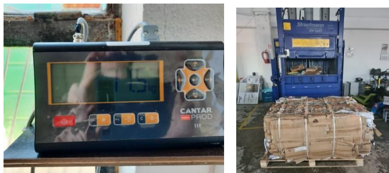
Fig.6.16. Presa pentru experimente și balotul legat obținut după compactare/balotare
