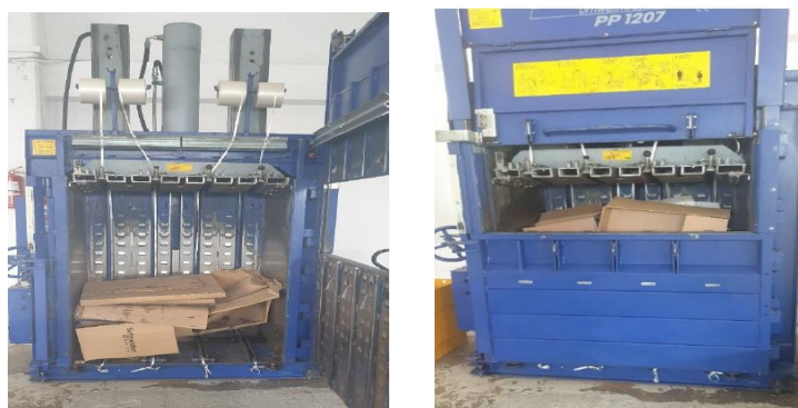
Fig.6.17. Aspecte din timpul determinării experimentale la compactarea cartoanelor
