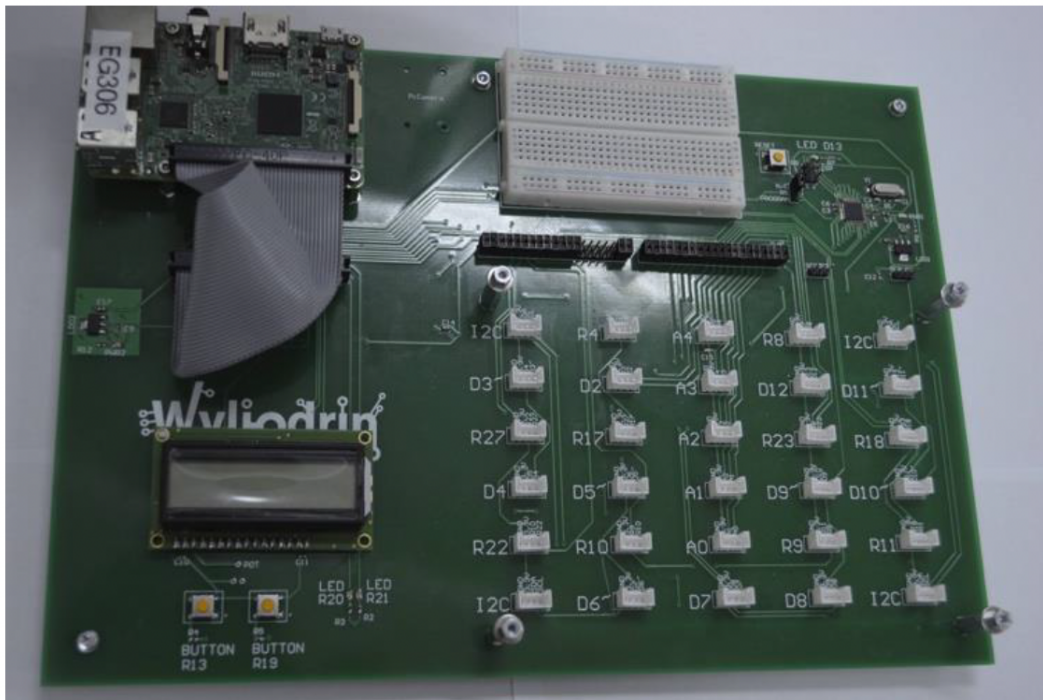
Figura 4: Extensia pentru Raspberry Pi.
