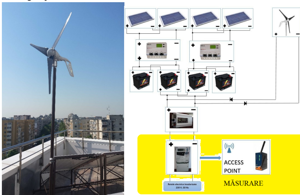
Fig. 6.4. Schema testare soluție constructivă nr. 3
