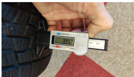
Figura 5.20 Măsurarea manuală a benzii de rulare a anvelopei cu un calibru digital.
