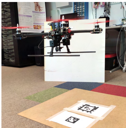
Figura 3.8 Drona care zboară în biroul nostru. Imaginea a fost realizată după ce a fost achiziționată țigeta și camera a fost orientată automat spre țintă.
