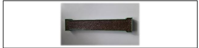
Figura 2.31 Specișen de test din granit epoxidic
