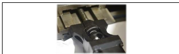
Figura 5.2 Lagăr mașină-unealtă - structură experimentală
