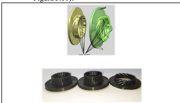
Figura 5.10 Sistem de ajustare axial realizat cu ajutorul lamelelor cu complianță; a) construcție finală; b) stadii evoluție formă
