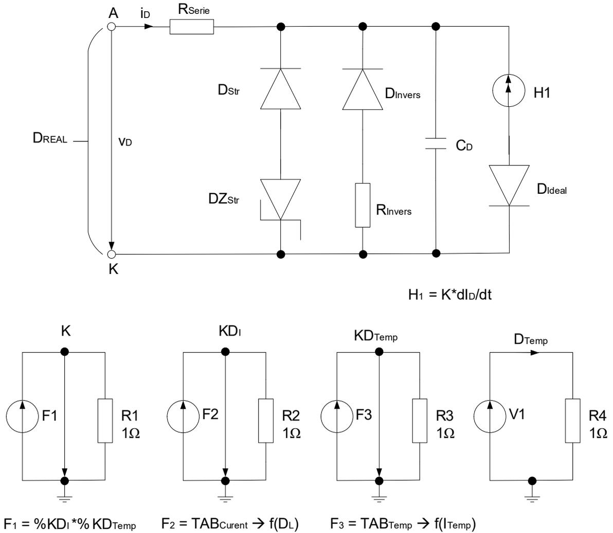
Fig. 4.1.2. SPICE model of a real rectifier diode.
