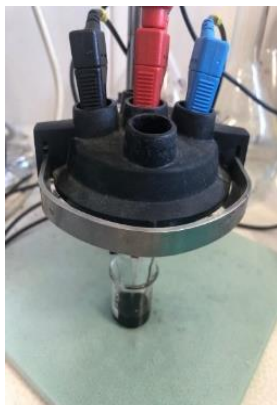
Figura 2.1. Utilizarea senzorului stocastic pentru screening-ul unei probe de sânge.
