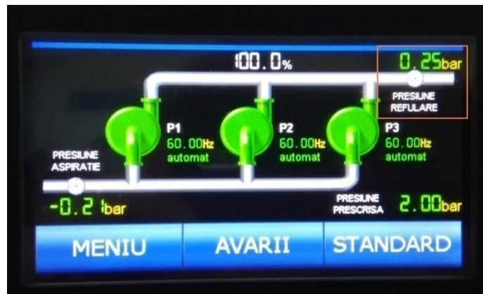
Fig. 4.3. Ecran senzorial HMI: afișarea presiunii relative de la refulare, măsurată cu unul dintre traductoarele de presiune TR1 sau TR2 ("presiune refulare", aici p_{ref} = 0.25 bar); în situația prezentată, toate pompele funcționează cu turația nominală, iar sistemul nu poate asigura valoarea presiunii prescrise ( p_{PSP} = 2 bar), deci în acest caz, p_{ref} \ll p_{PSP}
