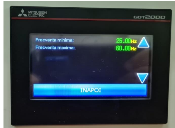
Fig. 2.25. Ecran senzorial: setare frecvență minimă și maximă
