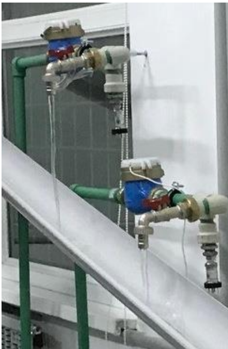
Fig. 2.20. Jeturile de apă de la consumatorii finali, colectate în canalul jgheabului
