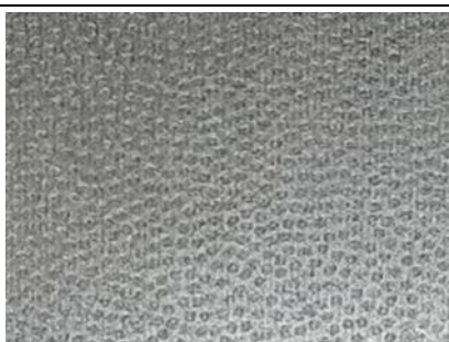
Fig. 5.44 Texturare cu regimul LBM1 , oțel DIN 1.2311
