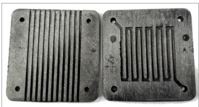
Fig. 8.10 Plăci bipolare formate prin injecție (C3), proba nr. 27 catod, nr. 26 anod.
