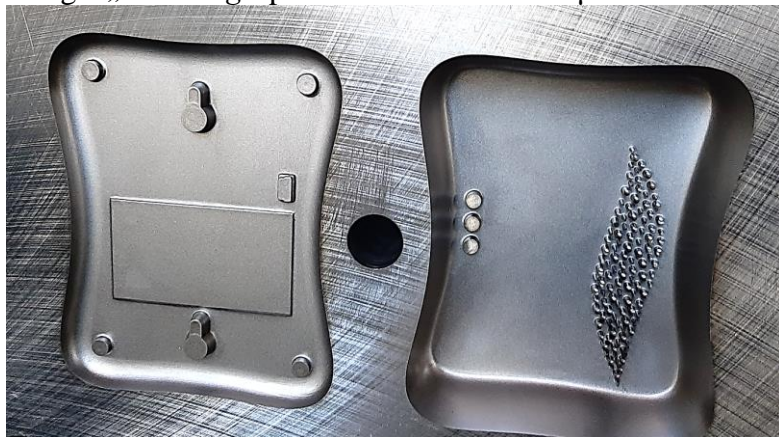
Fig. 5.46 Texturare VDI 3400 #22 prin electroeroziune, cu amabilitatea LS INTEH srl
