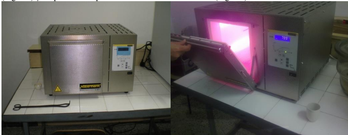
Figura 5.1. Cuptor Nabertherm pentru determinarea conținutului de cenușă
