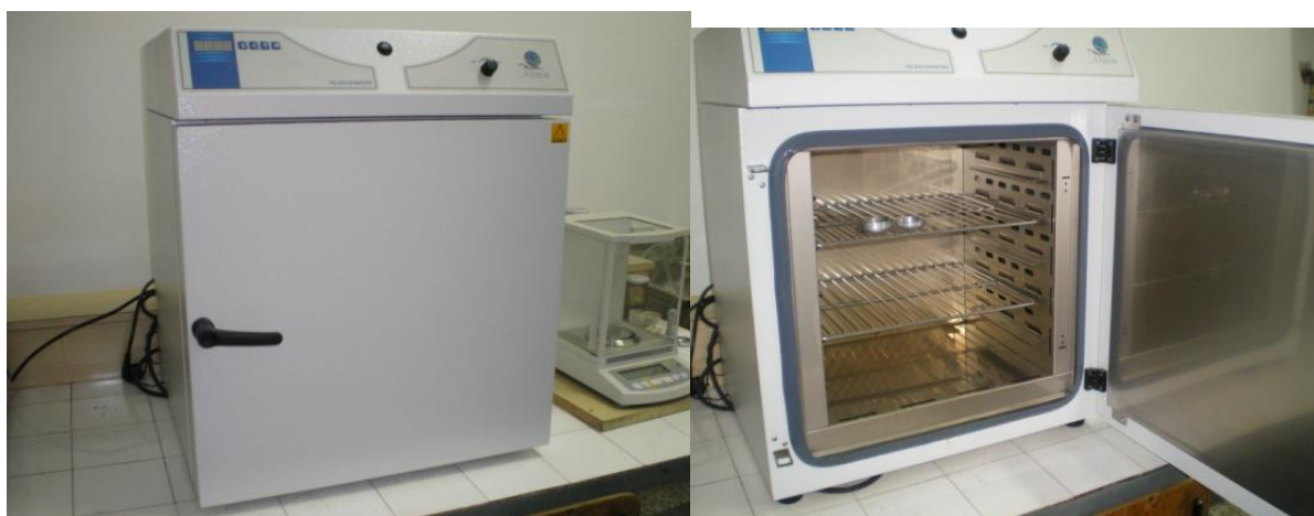
Figura 5.1. Cuptor Nabertherm pentru determinarea conținutului de cenușă
