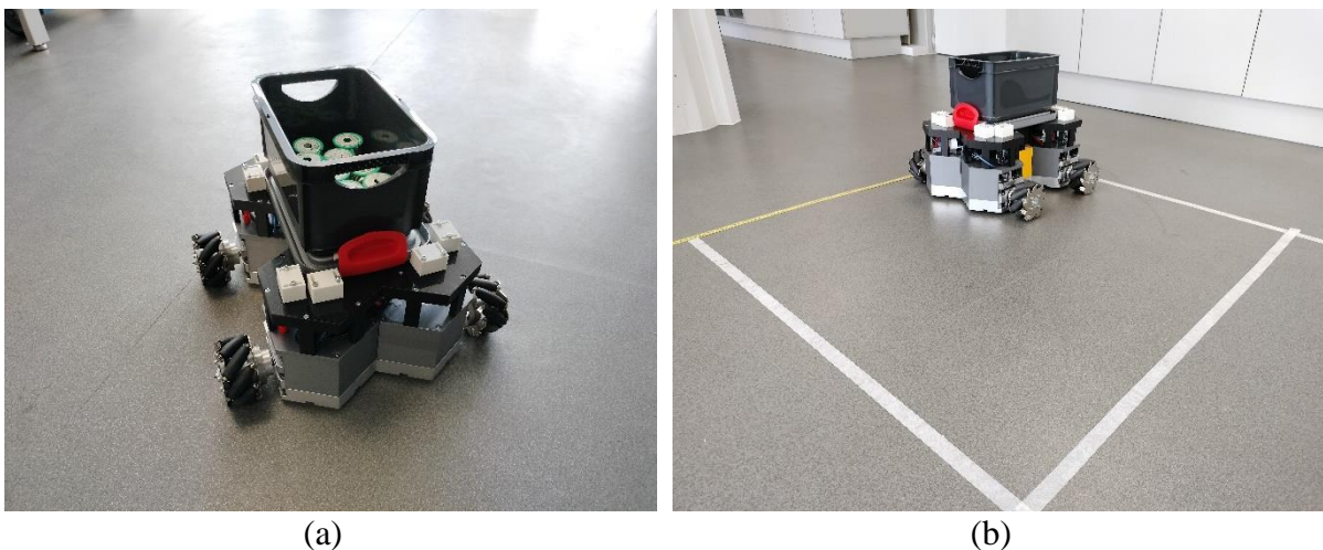
Fig. 6.29 Traectoria fizică și robotul mobil real cu patru roți mecanum: (a) vedere de aproape; (b) robotul mobil pe traseu.
