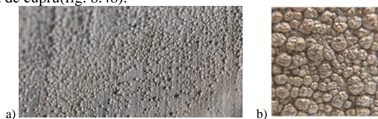
Figura 8.48. Detalii de tehnică (verso) în care se observă stratul de argint pur după electrolitic (argint coloidal) pe matricea de cupru.
