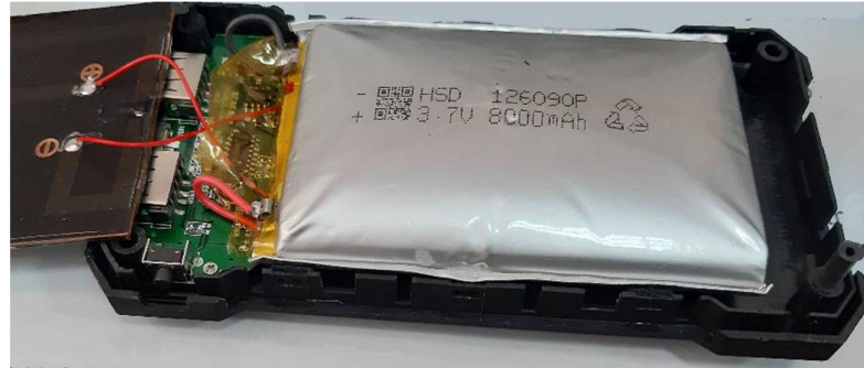
Figura 7.2. Acumulator litiu-polimer utilizat într-o baterie externă, supraîncărcat
