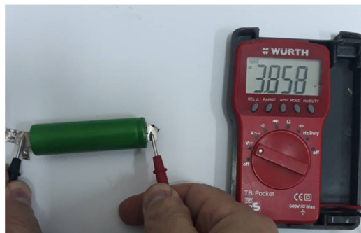
Figura 8.6. Acumulator litiu-ion utilizat pentru revitalizarea acumulatorului.
