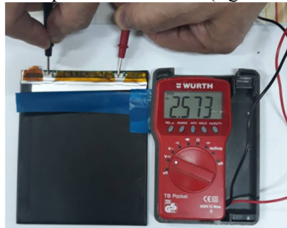
Figura 8.5. Acumulator de tabletă în stare inițială. Măsurarea tensiunii nominale a acumulatorului
