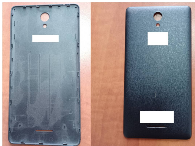
Figura 7.8. Capacul intact al telefonului al cărui acumulator s-a autoaprins
