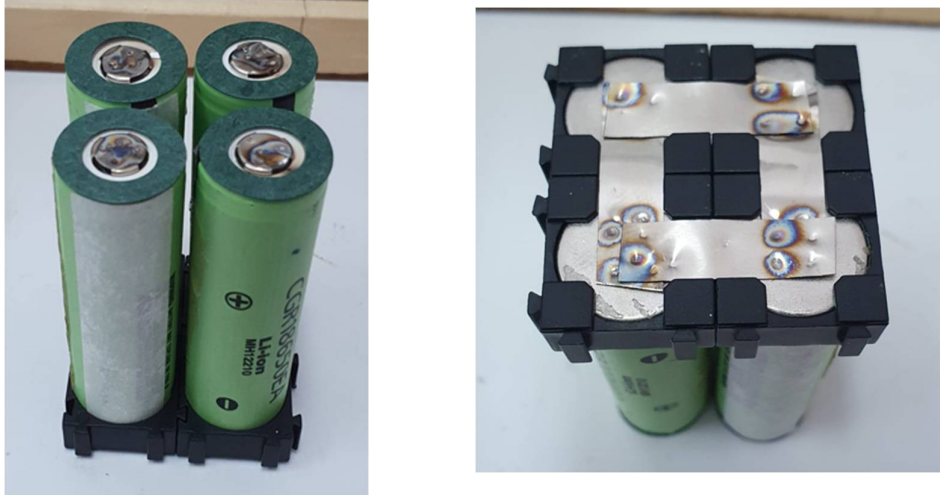
Figura 13.1. Acumulatori litiu-ion MH12210 prevăzută cu sisteme modulare de cuplare și inele izolatoare pentru prevenirea scurt-circuitelor accidentale
