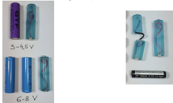
Figura 6.3. „Dummy cells” scurtcircuitate pentru a asigura continuitatea electrică
