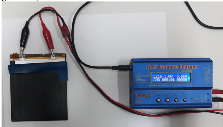
Figura 8.10. Încărcarea acumulatorului pe bază de litiu cu încărcătorul profesional dedicat după etapa de revitalizare
