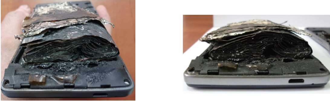
Figura 7.7. Imagine detaliată a unui acumulator litiu-polimer ce a suferit un proces de autoaprindere.
