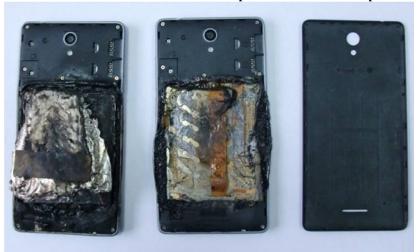
Figura 7.6. Acumulatori litiu-polimer care au suferit un proces de autoaprindere
