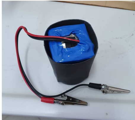
Figura 13.3. Baterie de acumulatori litiu-ion cu conectorii atașați
