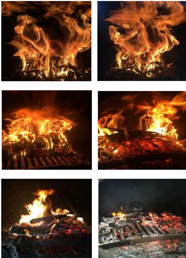
Fig. 9. Imagini ale procesului de ardere din interiorul focarului cazanului pilot de 55 kW la diferite momente ale experimentului 1
