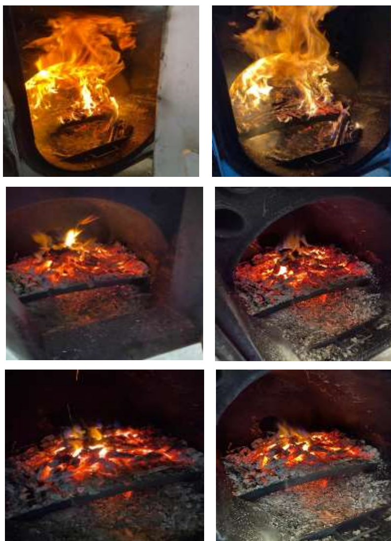
Fig. 11. Imagini ale procesului de ardere din interiorul focarului cazanului pilot de 55kW la diferite momente ale experimentului 2
