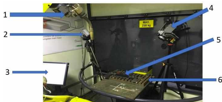
Fig 3.1 Celula robotizată de sudare: 1. Robotul industrial Fanuc 100 iB 2. Pirometrul Raynger MX4 3. PC pentru achiziții date pirometru, 4. Camera de termografie, 5. Placa de oțel, 6. Masă modulară
