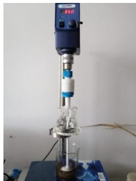
Figura 4.10. Epurarea apei folosind nanomaterialul oxidic Fe_3O_4 .
