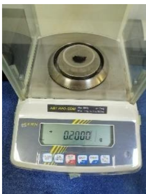
Figura 4.9. Cântărirea nanomaterialului oxidic Fe_3O_4 .
