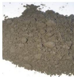
Figura 7.2 Deșuri proteice măcinate într-o moară criogenică
