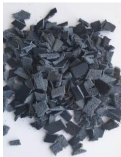
Figura 7.1 Deșuri proteice măcinate într-o moară cu cuțite și sită
