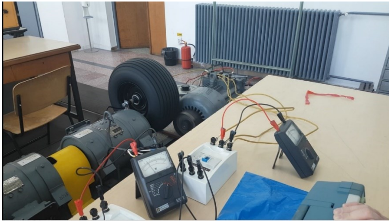
Fig. VIII-9. Funcționarea motorului PM ca generator pentru primele determinări
