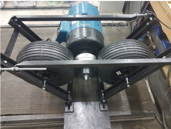
Fig. VIII-2. Platformă cu două motoare în roată – imagine asupra cuplajului dintre roți
