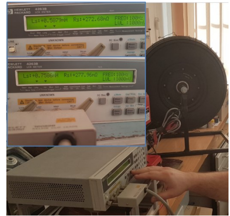
Fig. VIII-10. Motor PM – măsurarea rezistenței de fază și a inductanțelor
