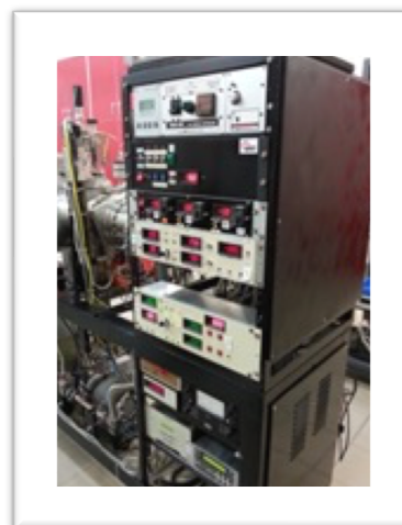
Figura 5.2. Sistemul de comandă și control al instalației de depunere
