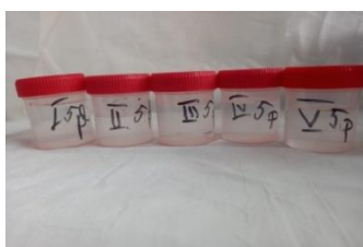
Fig. 5.12. Probe prelevate în timpul utilizării a cinci plante Typha angustifolia în studiul efectuat pe apă uzată ce conține ioni de Pb^{2+} .
