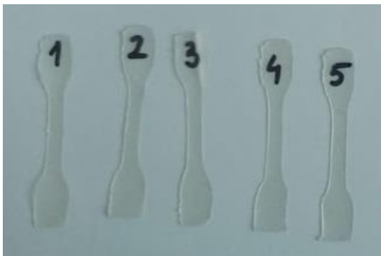
Figura 4.3 Epruvete din filmele pe bază de amidon de porumb realizate pentru determinarea încercărilor mecanice
