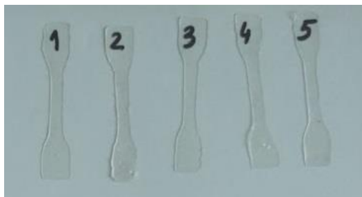
Figura 4.1. Epruvete din filmele pe bază de amidon de cartof realizate pentru determinarea încercărilor mecanice
