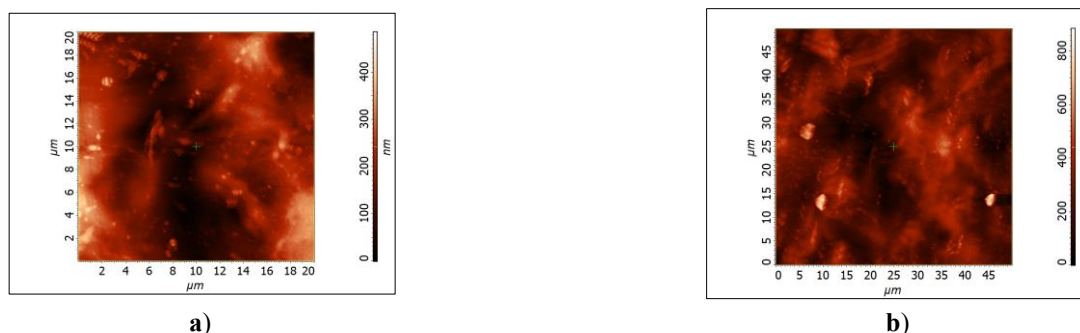
Figura 5.7 Imagini 2D ale probelor AHO caracterizate prin AFM: a) 20 × 20 μm; b) 50 × 50 μm
