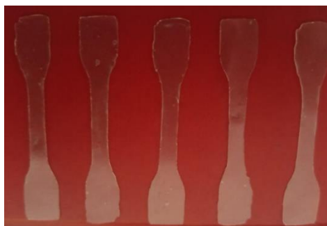
Figura 6.2 Epruvete din filme pe bază de pectină hidrolizată realizate pentru încercări mecanice
