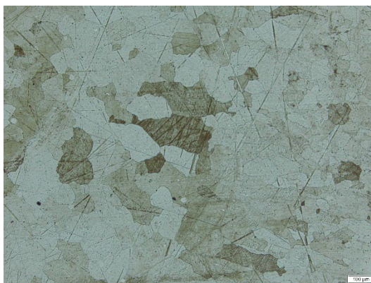
Fig. 5.3. Imagini de microscopie optică a probei 1 – calită pentru punere în soluție. Atac Marble ( M = 100x );
