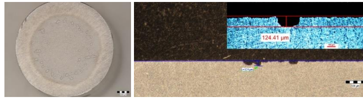
Fig. 13- Aspectul suprafețelor macrostructurale (stanga secțiune frontală, paralelă cu suprafața erodată, dreapta în secțiune transversal, fundal – imagine la microscopul optic, detaliu- imagine la stereomicroscop) supuse la eroziunea cavitațională din aliaj Al-Mg, turnat urmat de calire de punere în soluție 350°C / menținere 100 min / racire aer linistit și supus la îmbatrănire artificială la 180 °C și diferite durate de menținere: a- 1h; b- 12h; c- 24 h
