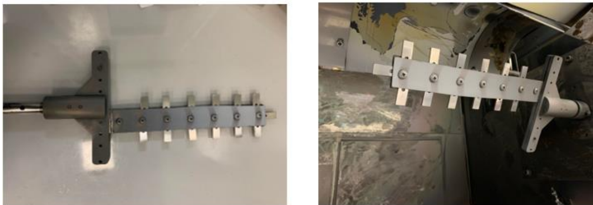
Fig. 7.1. Fixarea plăcutelor de substrat în dispozitiv și cuplarea dispozitivului la mecanismul de rotire.
