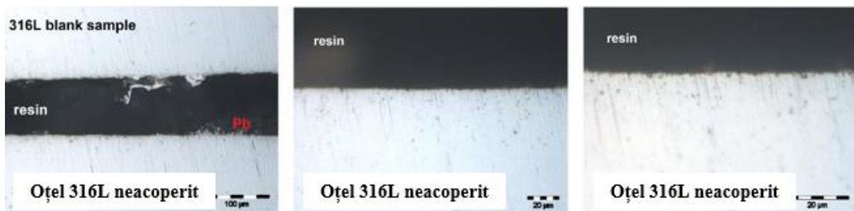
Fig. 7.15. Secțiune transversală a unei probe de inox 316 L neacoperite testat timp de 500 de ore în plumb lichid la diferite ordin de mărime: X 200; X 500; X 1000.
