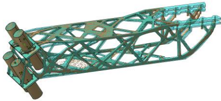
Fig. 33 Transpunerea remodelării CAD ( turcoaz ) peste rezultatele obținute din optimizare ( vișiniu )
