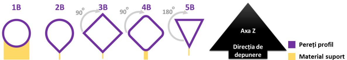
Fig. 37 Dependenta formelor ideale pentru cavități în funcție de orientarea piesei în platforma mașinii de fabricație aditivă (contribuție proprie)
