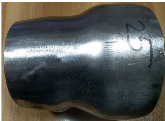
Fig. 39 - Deformarea plastică a țevii după utilizarea penetratorului cu unghiul la vârf de 50°
