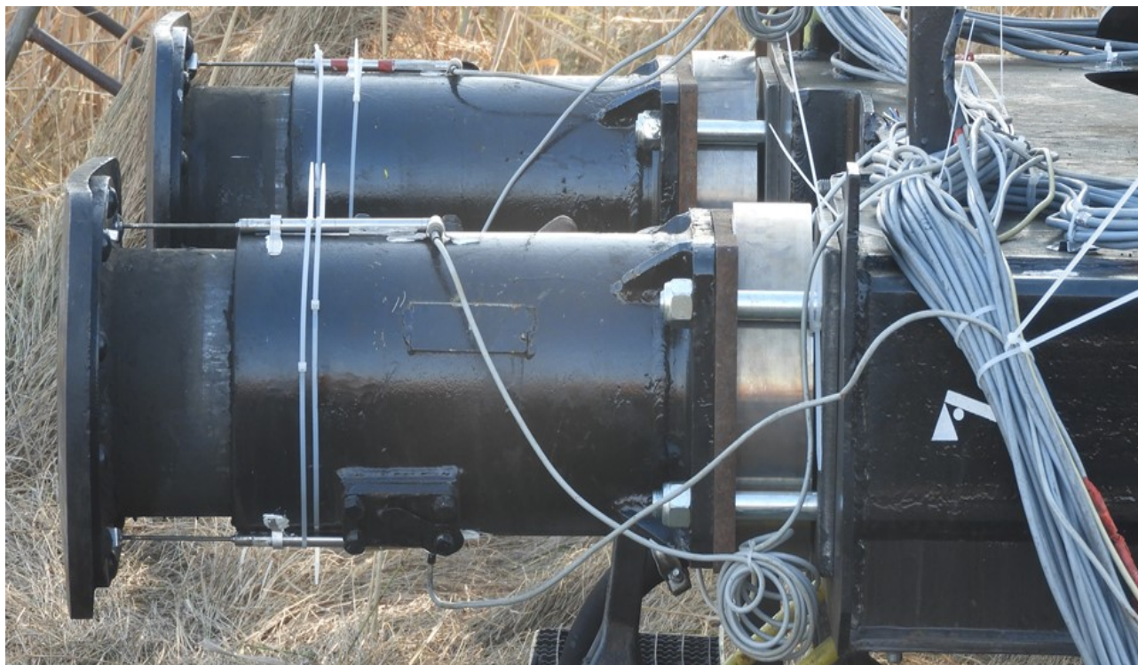
Fig. 33 - Montajul ansamblului de senzori pe cele două tampoane
