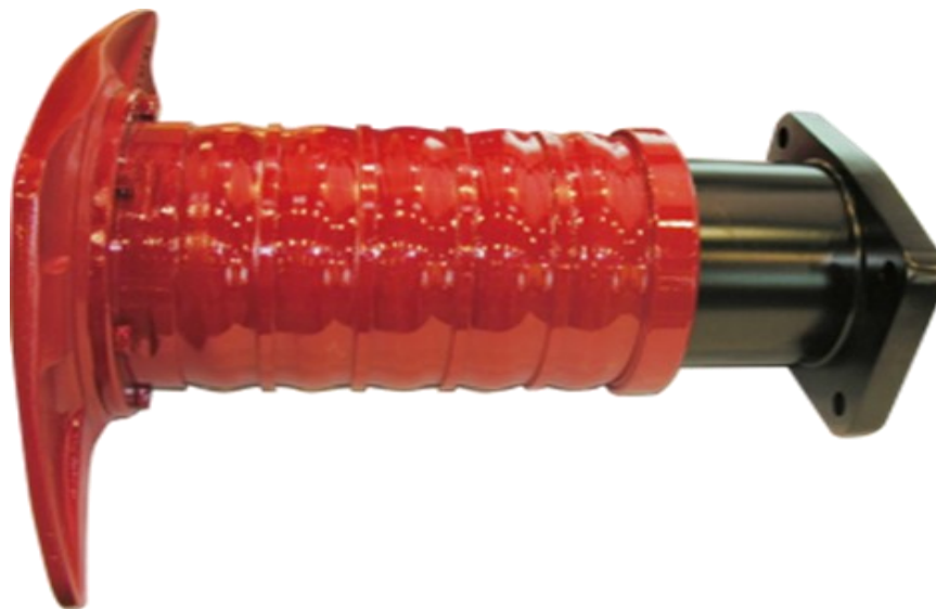
Fig. 10 - Tampon crash ce utilizează metoda plierii pentru absorbirea energiei de impact
