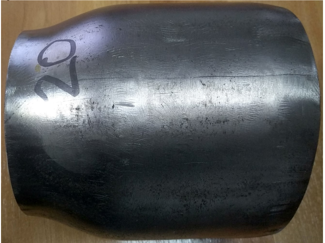
Fig. 38 - Deformarea plastică a țevii după utilizarea penetratorului cu unghiul la vârf de 40^{\circ}
