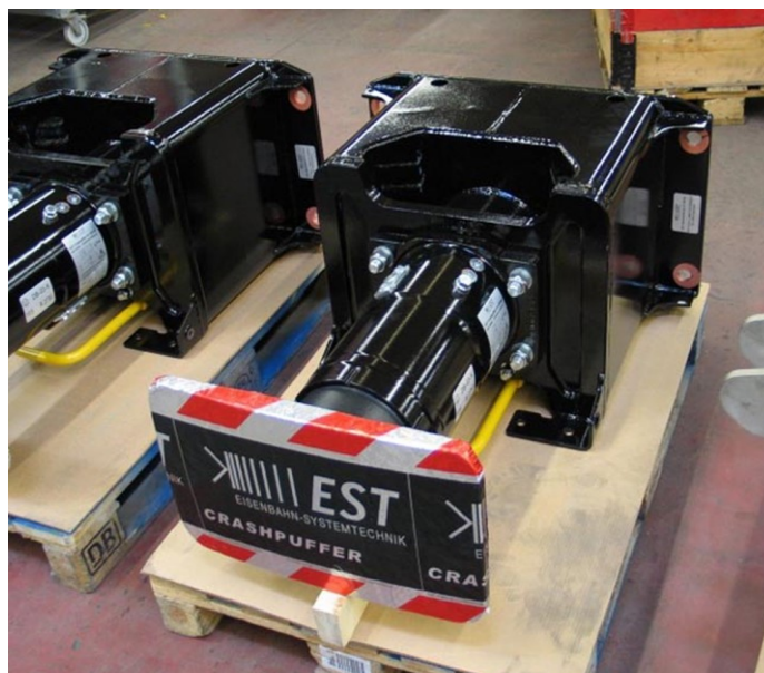
Fig. 6 - Sistem de crash deformabil în două etape tip EST Duplex G2.A2
