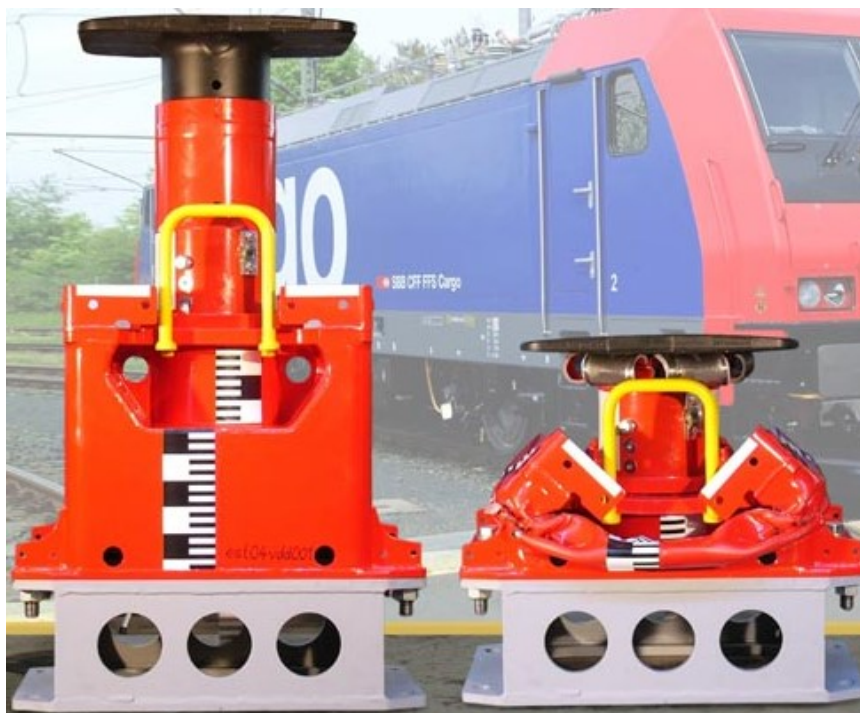
Fig. 5 - Sistem de crash deformabil în două etape tip EST Duplex G1.A1
