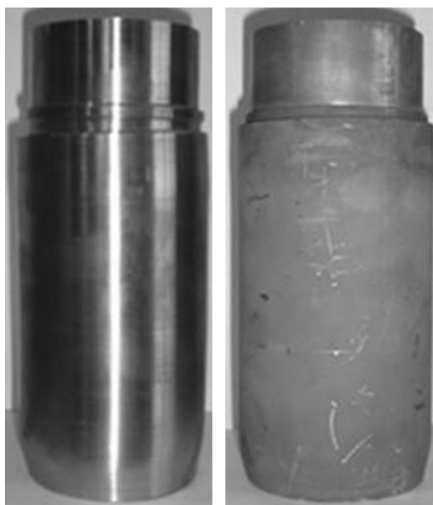
Fig. 14 - Ansamblul de țevi după deformare
