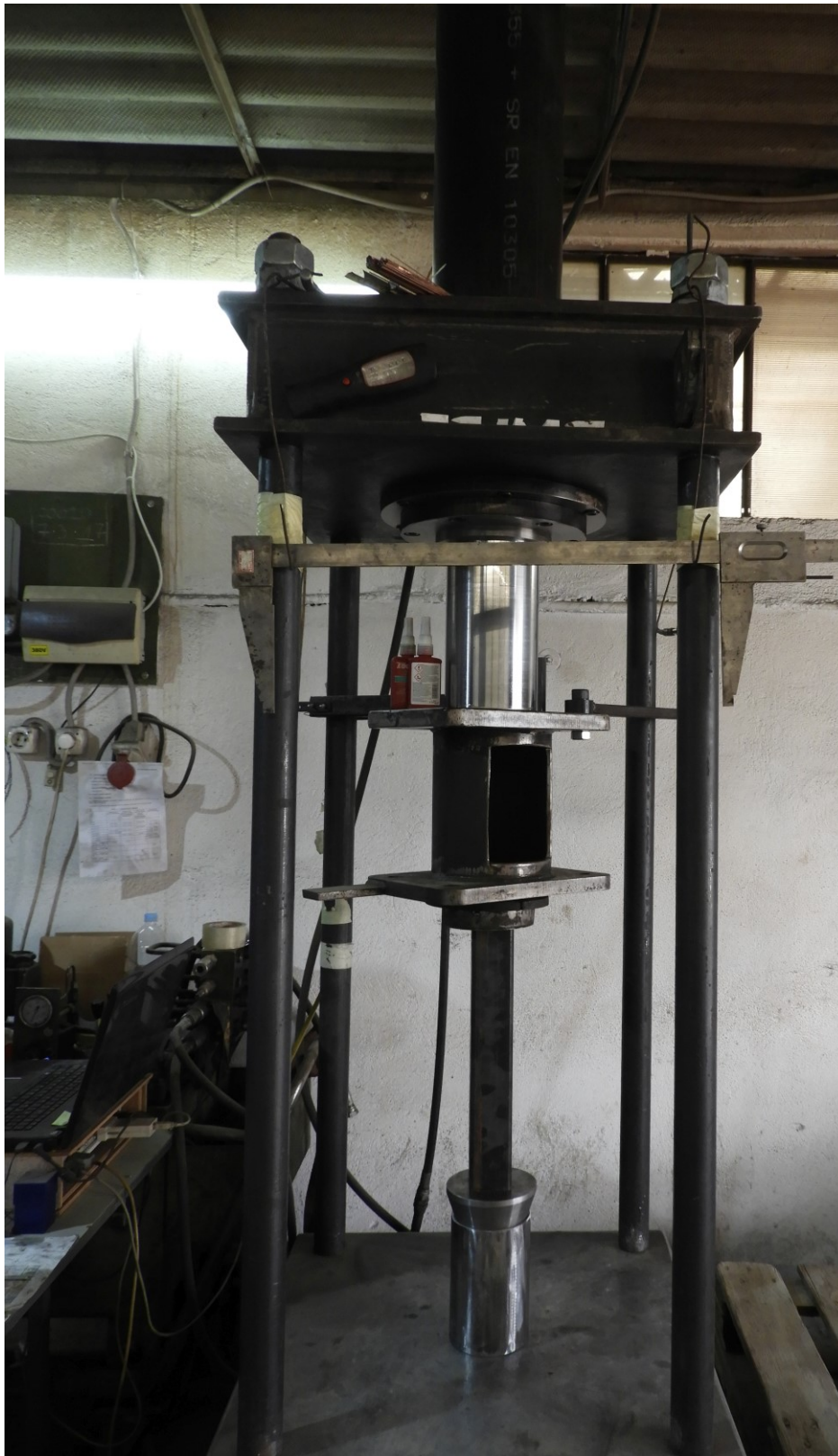
Fig. 37 - Montaj de test pe presa hidraulică
