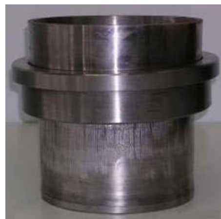
Fig. 17 - Dispozitivul după deformarea plastică a țevii
