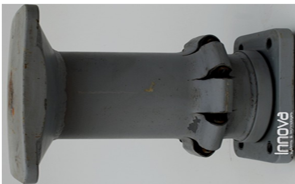
Fig. 4 - Tamponul INNOVA de 400 kJ după deformare
