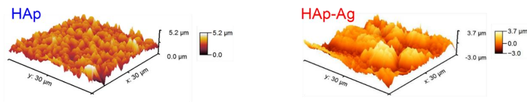
Figura 4.10. Imagini AFM cu topografia suprafeței acoperirilor dezvoltate
