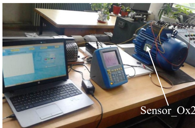
Fig. 7.1. Sistem experimental pentru investigarea câmpului magnetic extern și generarea de scurtcircuite artificiale
