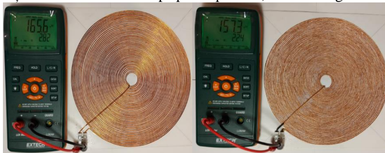
Fig. 3.6. Verificare inductanță proprie bobină tip spirală planară (variantele D, E)
