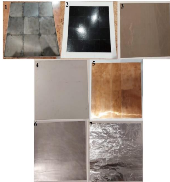
Fig. 5.1. Ecrane utilizate în procesul de ecranare a bobinei de emisie
